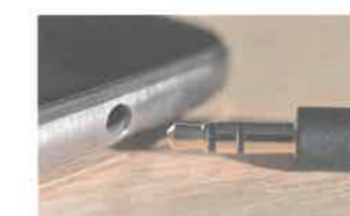
Obr. 3 – Konektor Jack 3,5 mm, který přenáší zvukový signál, je nejstarší typ konektoru, o kterém tu mluvíme.
